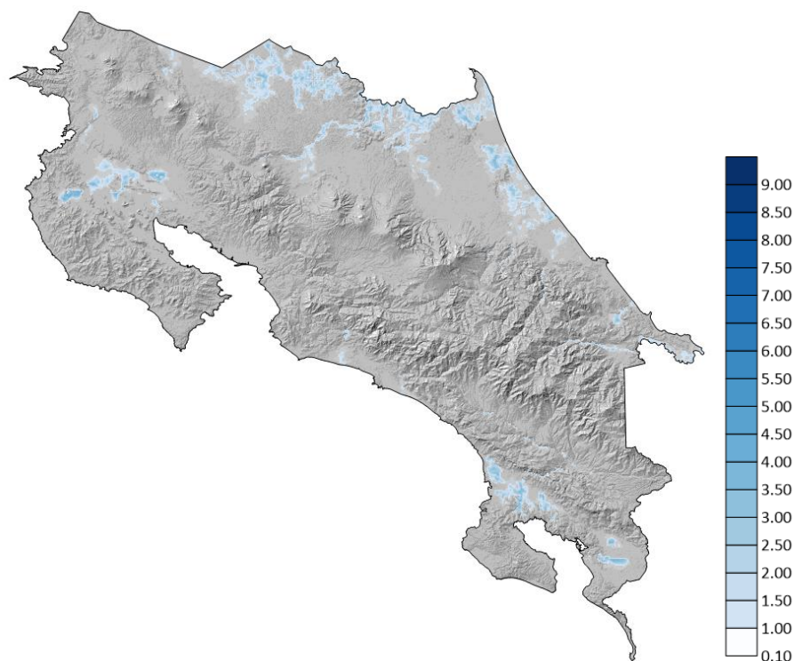
Figura 80. Mapa de amenaza de inundación fluvial para clima base. TR = 25 años. Profundidad de inundación en metros.
